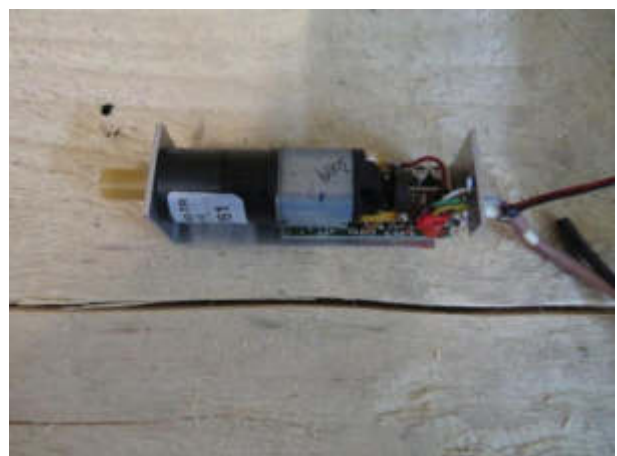
Bild 6 Defekter Motor durch Überspannung
