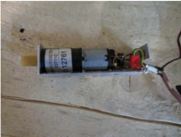
Bild 7 Defekter Motor durch Überspannung
